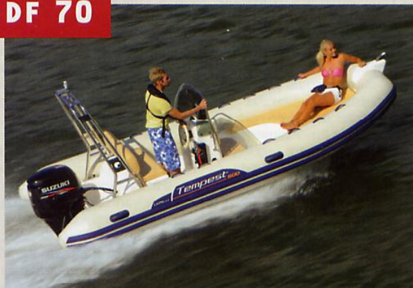
Com o Tempest 500 equipado com o DF70 e com três adultos a bordo planamos em 1,20 segundos e atingimos os 30,2 nós
